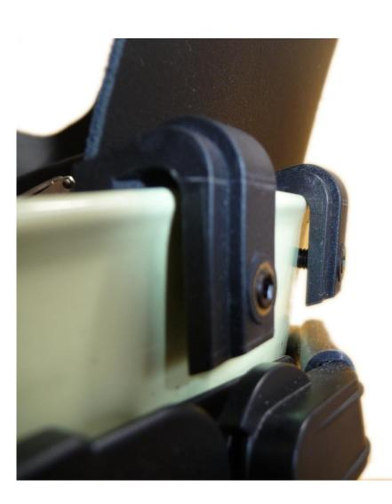
Die Schrauben mittels eines Imbussschlüssel Größe 2,5 eindrehen bis diese bündig mit der Adapteroberseite abschließen; die Grundplatte hebt sich dabei leicht an.
